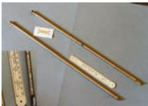
Рис. 5.2. Типові джерела для промислової стерилізації. Елементи з ^{60}\text{Co} у металевій формі. Приблизні розміри: 11 мм у діаметрі \times 450 мм завдовжки; звичайна активність нового джерела ^{60}\text{Co} : 444 ТБк (12 кКі)
