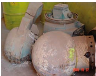
Робочі органи апаратів дистанційної променевої терапії старих конструкцій з джерелами ^{60}\text{Co}
