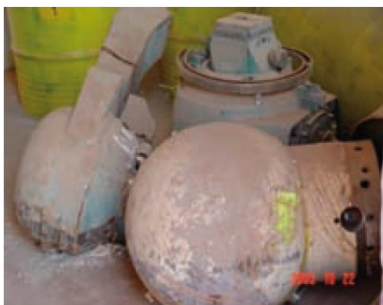
Робочі органи апаратів телетерапії старих конструкцій з джерелами ^{60}\text{Co}
