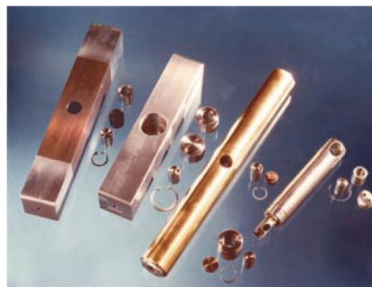
Різноманітні джерела ^{60}\text{Co} для телетерапії з відповідною арматурою для завантаження до робочого органу апарату променевої терапії
