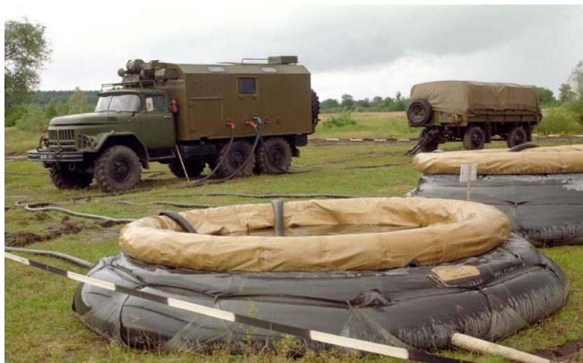
Рис.7.5. Модернізована автофільтрувальна станція МАФС-3
