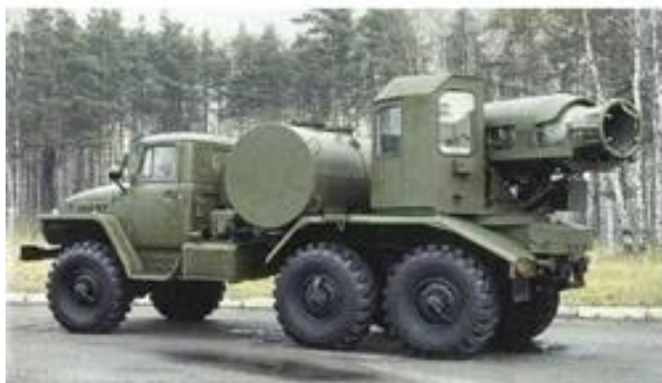
Рис.7.3. Теплова машина спеціальної обробки військової техніки (ТМС-65)
